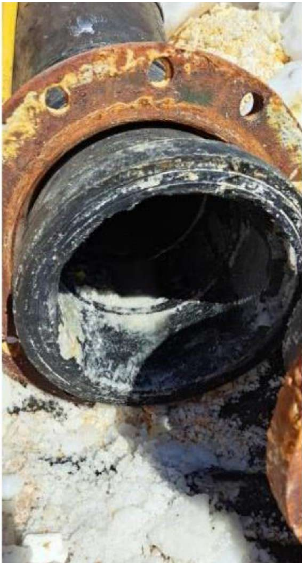
Incrustación en componentes (Flujómetro)
