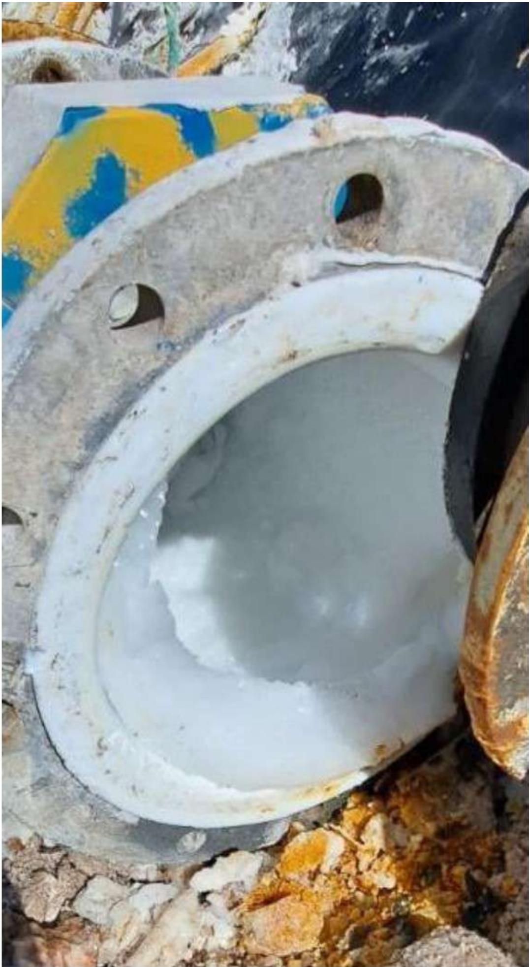
Incrustación en componentes (Flujómetro)
